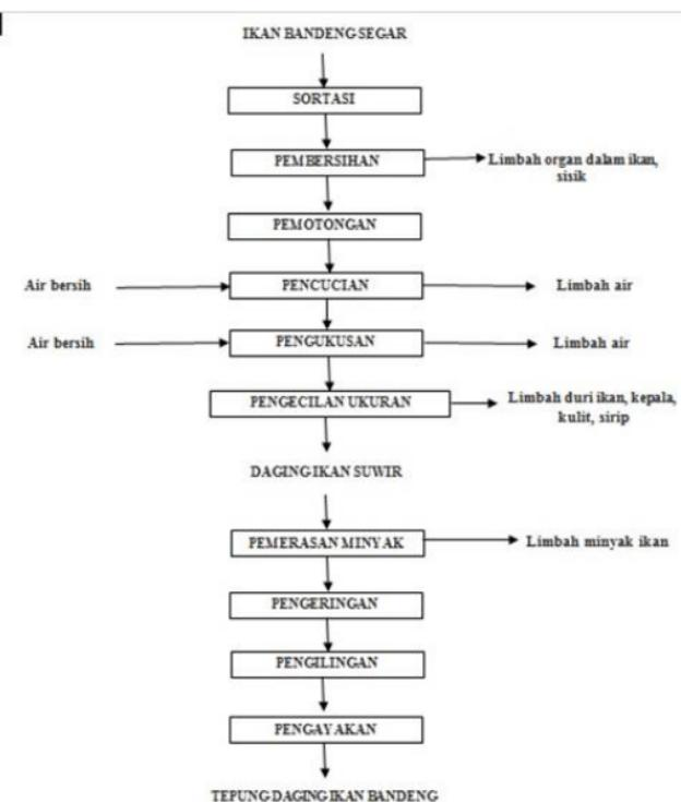
Gambar 1. Diagram Alir Pembuatan Tepung Daging Ikan Bandeng
