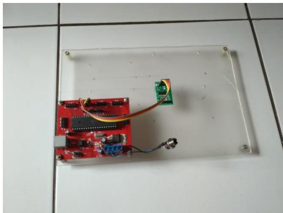
Gambar 3.6 Perangkat mikrokontroler dalam percobaan *soil bin*.
