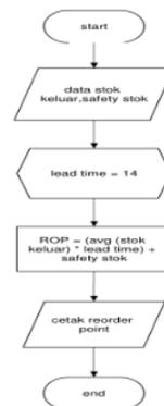
Gambar 2. Flowchart Hitung Reorder Point
