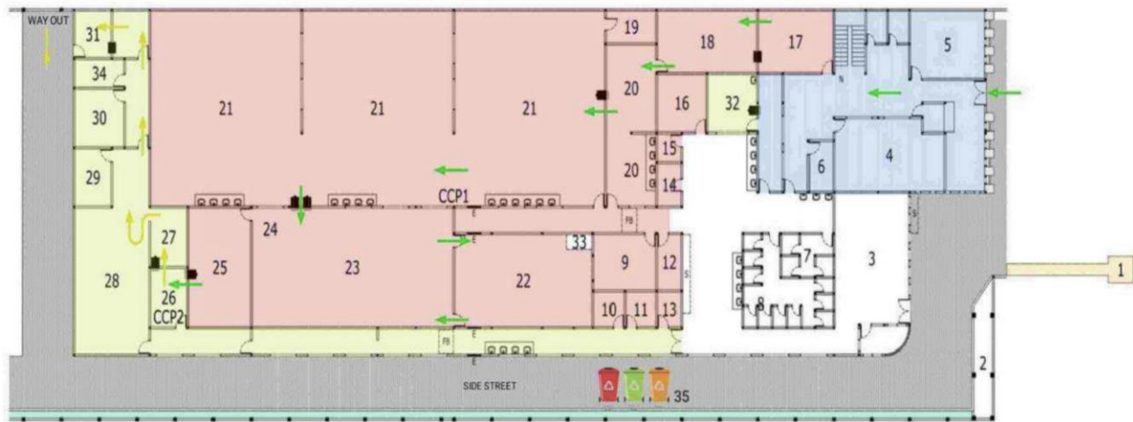
Gambar 28 Layout industri pencucian SBW dengan konsep zonasi pada produk
