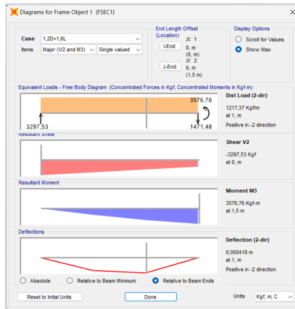
Gambar 5. 11 Gaya Dalam pada Tangga miring
