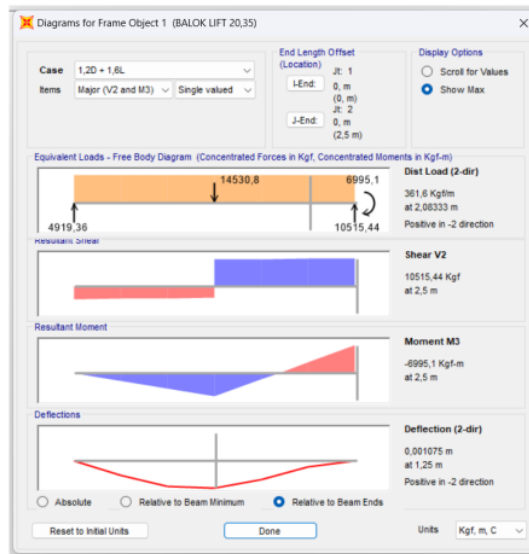
Gambar 5. 15 Gaya Dalam Tumpuan pada Balok Peggantung Lift
