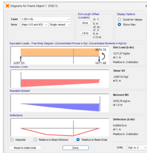
Gambar 5. 11 Gaya Dalam pada Tangga miring
