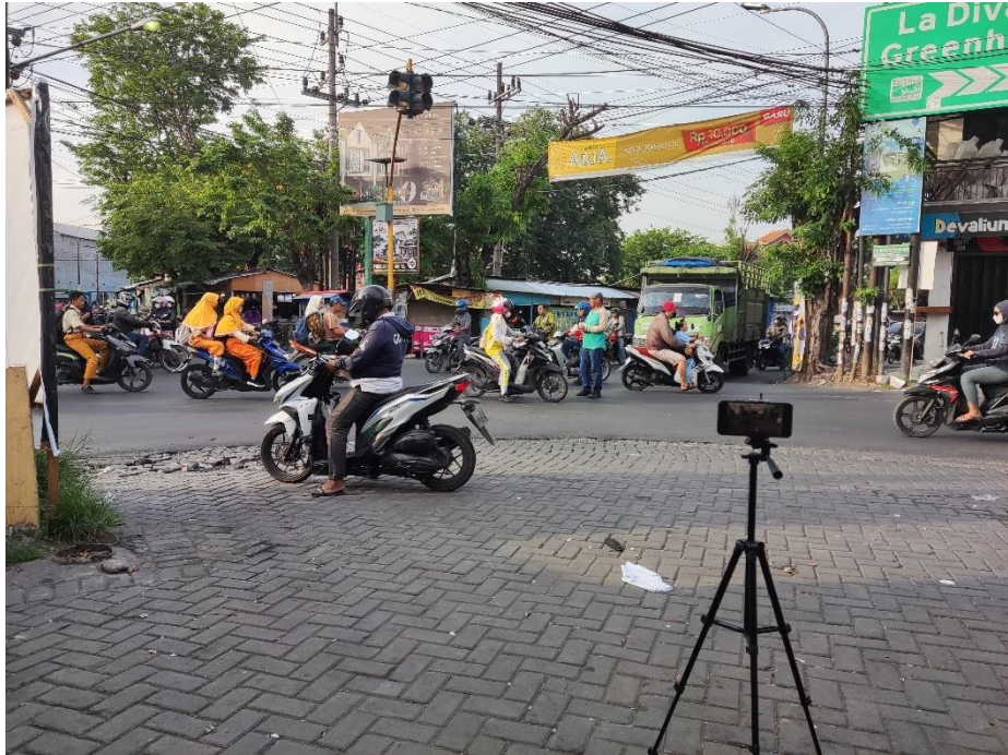
Gambar penempatan kamera untuk merekam arus lalu lintas simpang
