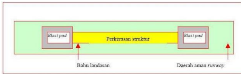
Gambar 2.1 Tampak atas elemen - elemen dasar runway
