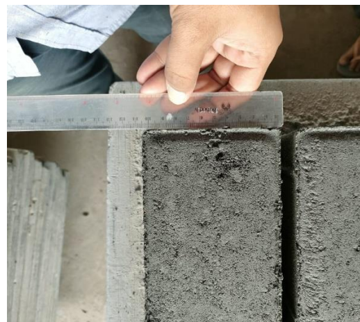
Gambar 23. Pengecekan Ukuran Hasil Pembuatan Paving Block
