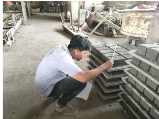
Gambar 21. Pengecekan Ukuran Hasil Pembuatan Paving Block
