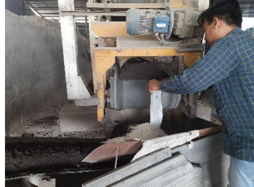
Gambar 13. Pemindahan Material dengan Conveyor
