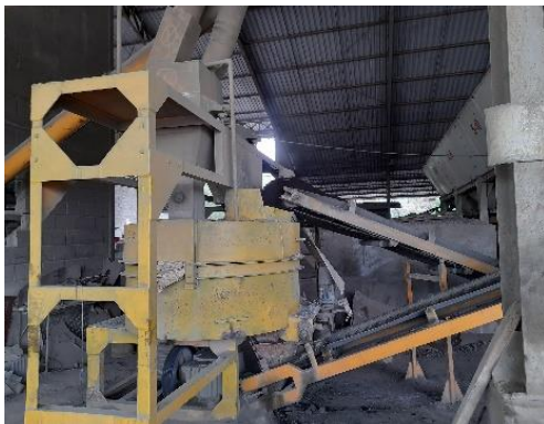
Gambar 14. Pencampuran Material didalam Mixer
