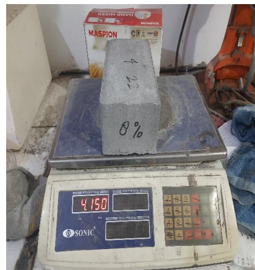
Gambar 90. Penimbangan Paving Kering Setelah Dioven
