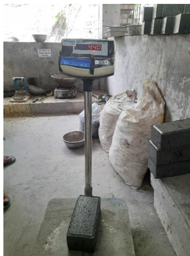
Gambar 89. Penimbangan Paving Block Basah Setelah Perendaman
