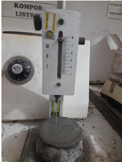
Gambar 1. Pengujian Waktu Mengikat dan Mengeras Semen
