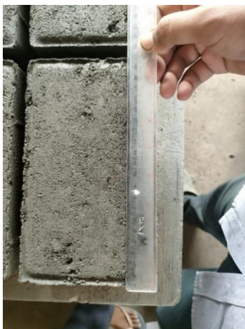
Gambar 22. Pengecekan Ukuran Hasil Pembuatan Paving Block
