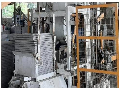
Gambar 16. Pellet Penempatan Paving Block
