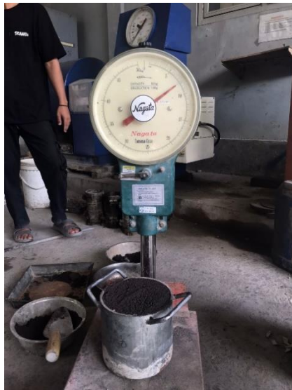
Gambar 10. Pengujian Berat Volume Pasir
