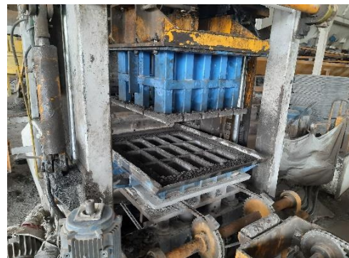
Gambar 17. Pencetakan Material Paving block Pada Block Moulding
