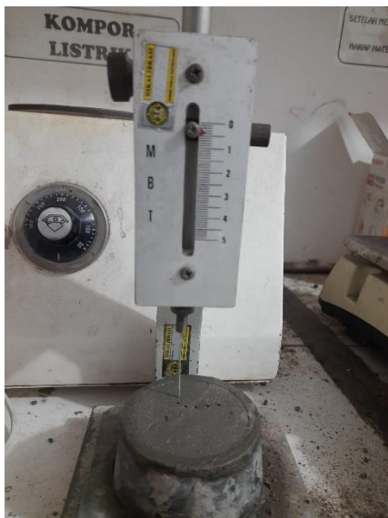
Gambar 3. Pengujian Waktu Mengikat dan Mengeras Semen + Cangkang Kerang
