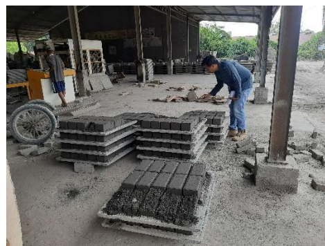
Gambar 3.16 Penempatan Paving Block Di Area Teduh
