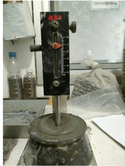
Gambar 2. Pengujian Konsistensi Normal Semen
