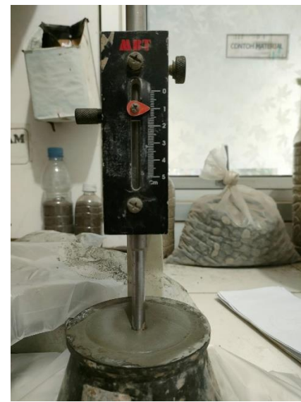
Gambar 4. Pengujian Konsistensi Normal Semen + Cangkang Kerang
