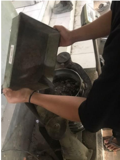
Gambar 8. Pengujian Analisa Gradasi Pasir
