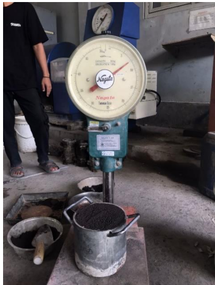
Gambar 10. Pengujian Berat Volume Pasir
