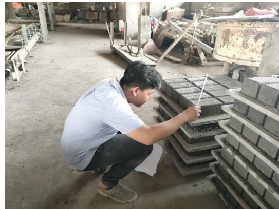
Gambar 21. Pengecekan Ukuran Hasil Pembuatan Paving Block
