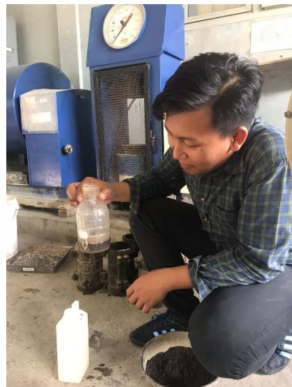
Gambar 11. Pengujian Kebersihan pasir terhadap bahan organik
