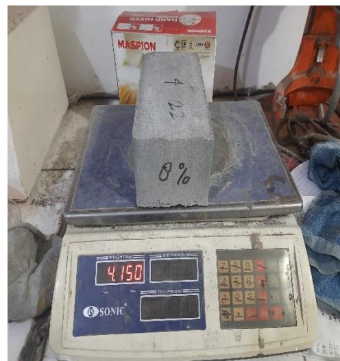
Gambar 90. Penimbangan Paving Kering Setelah Dioven
