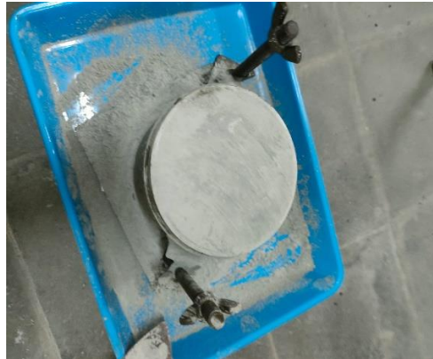
Gambar 1.7 Pengujian Berat Volume Semen
