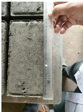
Gambar 22. Pengecekan Ukuran Hasil Pembuatan Paving Block
