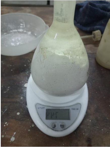
Gambar 5. Pengujian Berat Jenis Cangkang Kerang
