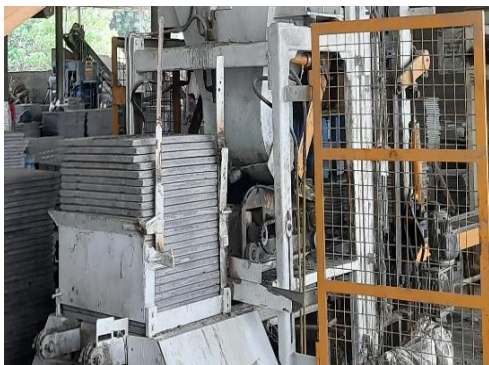
Gambar 16. Pellet Penempatan Paving Block
