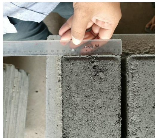
Gambar 21. Pengecekan Ukuran Hasil Pembuatan Paving Block
