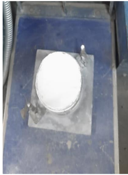
Gambar 6. Pengujian Berat Volume Cangkang Kerang
