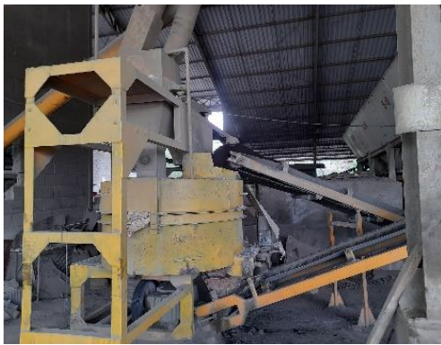
Gambar 14. Pencampuran Material didalam Mixer
