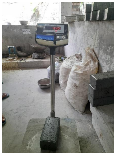
Gambar 89. Penimbangan Paving Block Basah Setelah Perendaman
