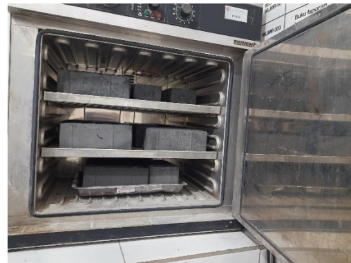
Gambar 88. Pengovenan Paving Block Selama 24 jam
