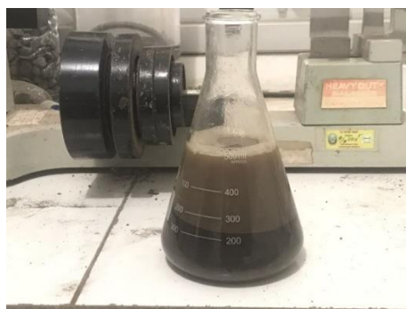
Gambar 4.12 Kebersihan Agregat Halus Terhadap Lumpur dengan Cara Basah
