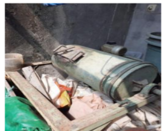
Gambar 3. 8 Penggilingan Cangkang Kerang
