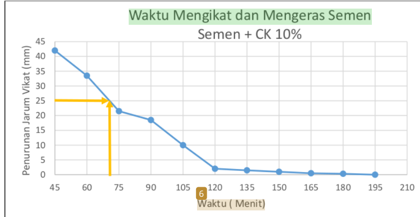
Gambar 4.10 Waktu Mengikat dan Mengeras Semen + Cangkang Kerang 10%
