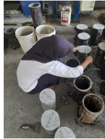
Pembukaan Silinder Benda Uji
