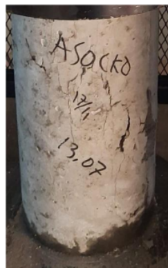
Gambar 4.21 Retakan Silinder Beton Tipe 3
