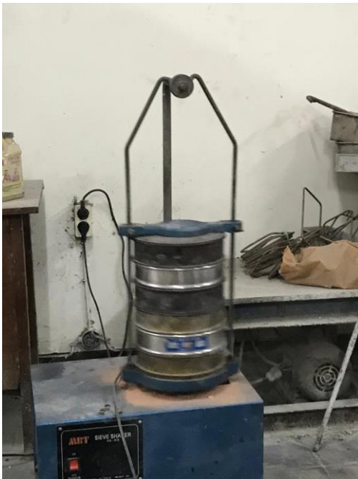
Analisa Gradasi Limbah Keramik
