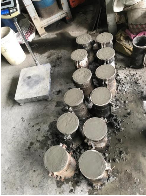
Proses Mencetak Benda Uji Beton
