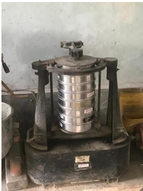
Pengujian Analisa Gradasi Pasir
