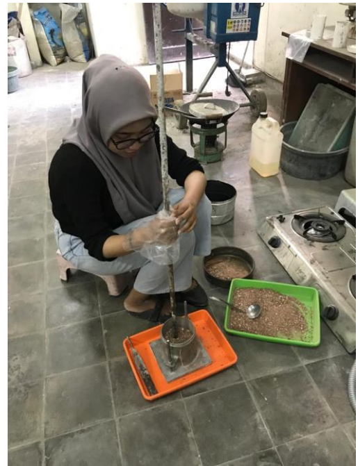
Pengujian Berat Volume Limbah Keramik
