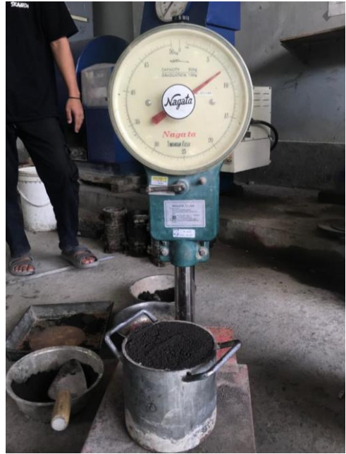
Pengujian Berat Volume Pasir
