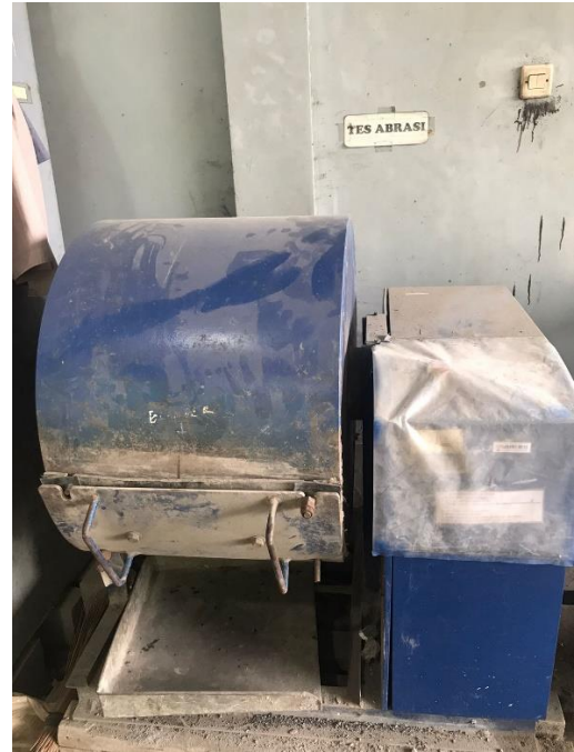
Pengujian Keausan Batu Pecah Dengan Mesin Los Angeles
