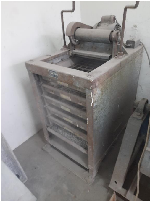
Pengujian Analisa Gradasi Batu Pecah
