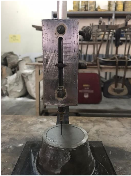
Pengujian Waktu Mengikat dan Mengeras Semen
