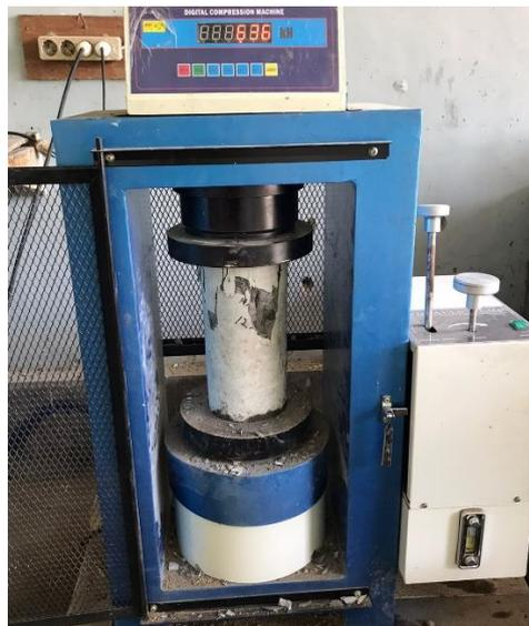
**Gambar 4.5** Pengujian Kuat Tekan Beton Pola Retak Kerucut dan Pecah
