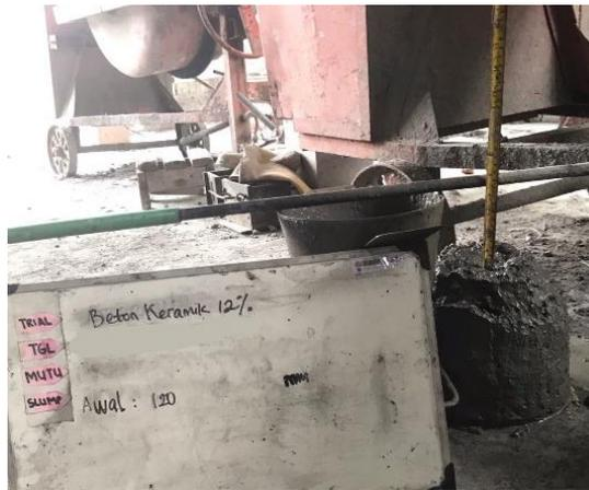
**Gambar 4.1** Pengujian *Slump*
