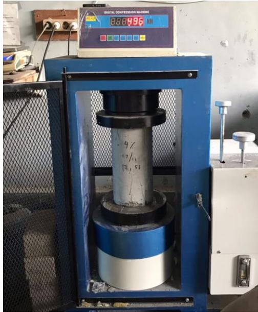
**Gambar 4.4** Pengujian Kuat Tekan Beton Pola Retak Kerucut
