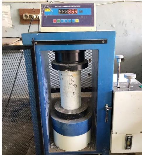
**Gambar 4.6** Pengujian Kuat Tekan Beton Pola Retak *Columnar*
