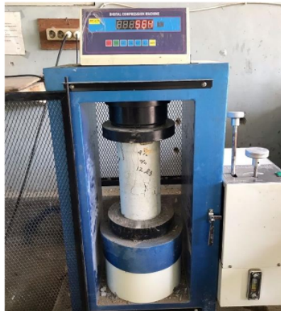
Gambar 4.6 Pengujian Kuat Tekan Beton Pola Retak Columnar
