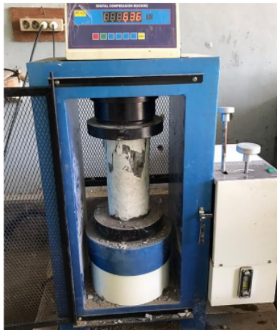
Gambar 4.5 Pengujian Kuat Tekan Beton Pola Retak Kerucut dan Pecah
