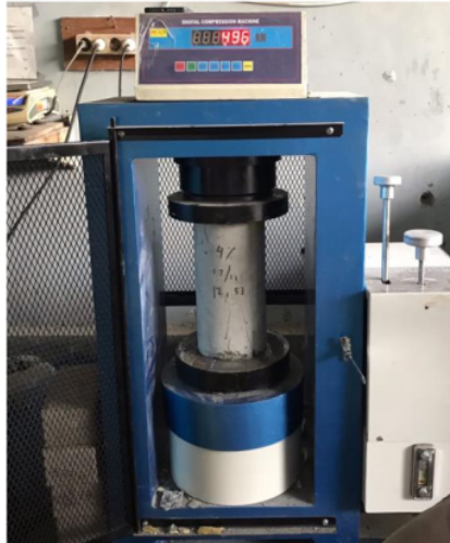
Gambar 4.4 Pengujian Kuat Tekan Beton Pola Retak Kerucut
