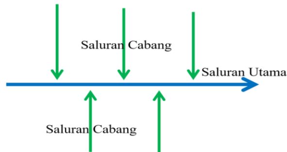
Gambar 2.5 Pola Pada Jaringan Saluran Drainase Siku
