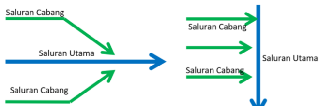
Gambar 2.4 Pola Pada Jaringan Saluran Drainase Pararel
