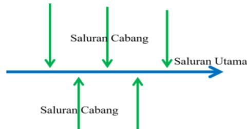
Gambar 2.5 Pola Pada Jaringan Saluran Drainase Siku
