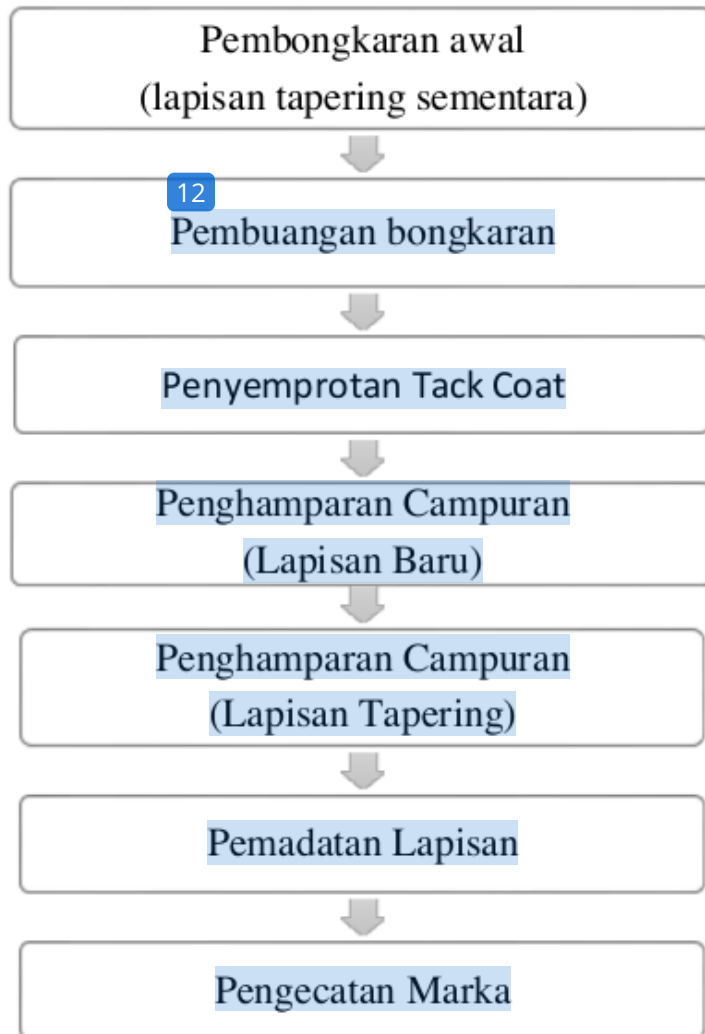
Gambar 4.1 Urutan Pekerjaan Pelapisan Ulang
