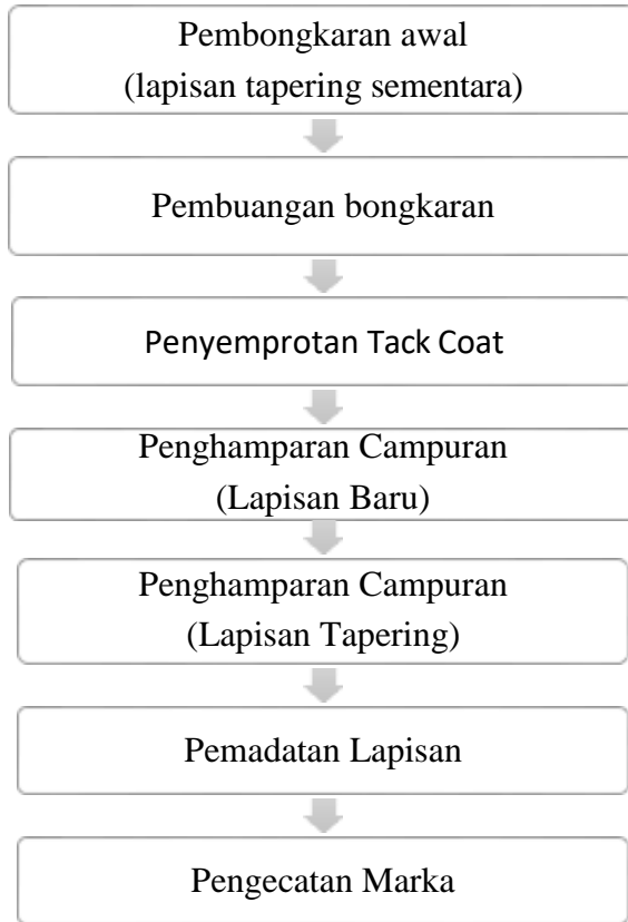
Gambar 4.1 Urutan Pekerjaan Pelapisan Ulang
