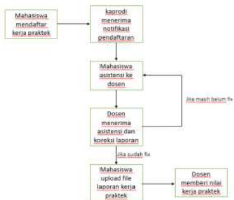
Gambar 1. Diagram blok sistem informasi Adapun diagram Context dari sistem monitoring KP yang dirancang ditunjukkan oleh Gambar 2.
