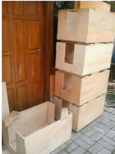
Gambar 3. 3 Kotak tanah sebagai pendukung dalam percobaan soil bin
