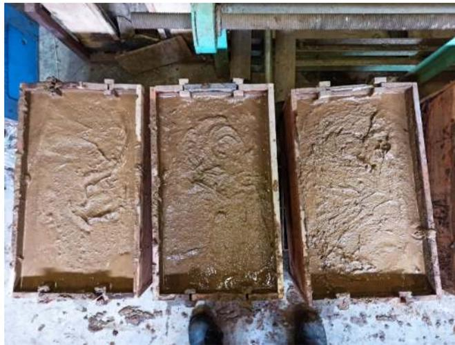
Gambar 3. 9 Persiapan tanah uji dan dilakukan penyiraman selama tiga sampai empat minggu pada percobaan *soil bin*
