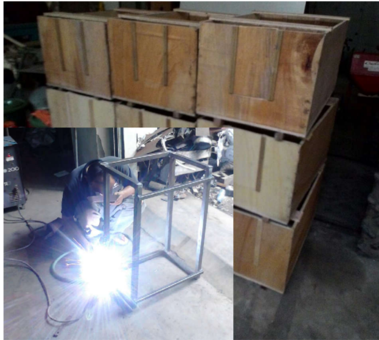
Gambar.3.3 Kotak tanah dan rangka besi sebagai pendukung dalam percobaan soil bin
