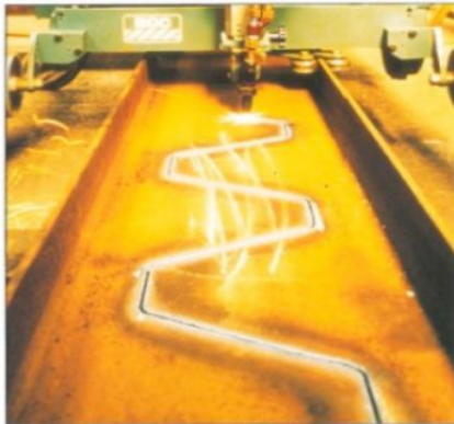
Gambar 3 Pola Pemotongan Profil Castellated Beam
