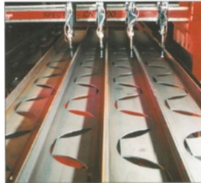
Gambar 4 Pola Pemotongan Cellular Beam
