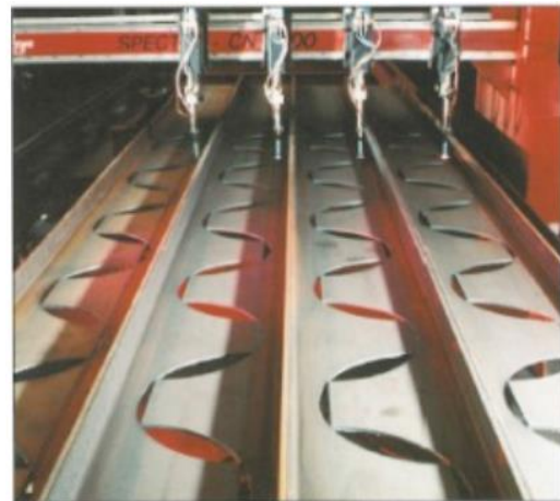
Gambar 4 Pola Pemotongan Cellular Beam
