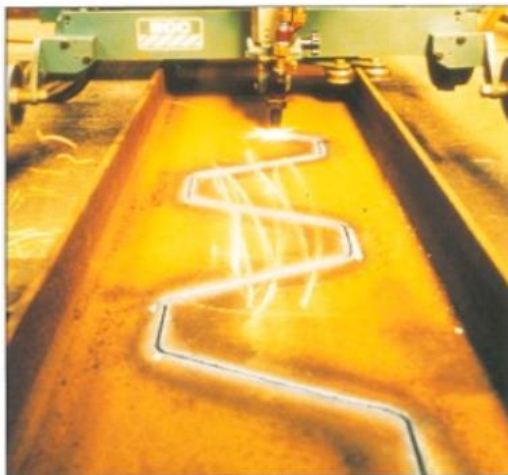
Gambar 3 Pola Pemotongan Profil Castellated Beam
