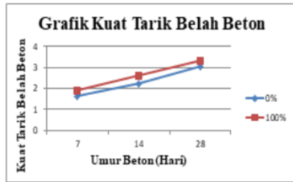
Gambar 5. Hasil Uji Kuat Tarik Belah Beton
