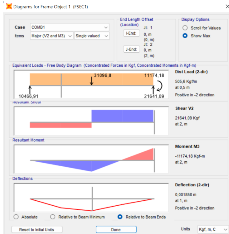
Gambar 5.17 Gaya Dalam Tumpuan Balok Penggantung Lift
