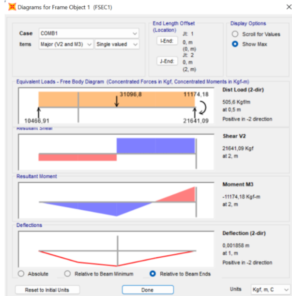
Gambar 5.17 Gaya Dalam Tumpuan Balok Penggantung Lift
